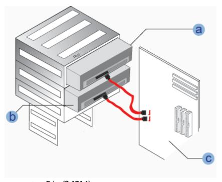
a : Drive (S-ATA 1)b : Drive (S-ATA 2)c : Mainboard
